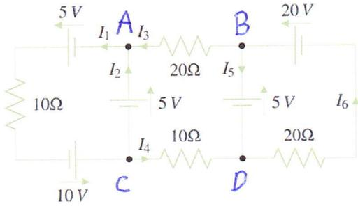
Junction A  $\Rightarrow I_2 + I_3 = I_1$ , or  $I_1 - I_2 - I_3 = 0$
